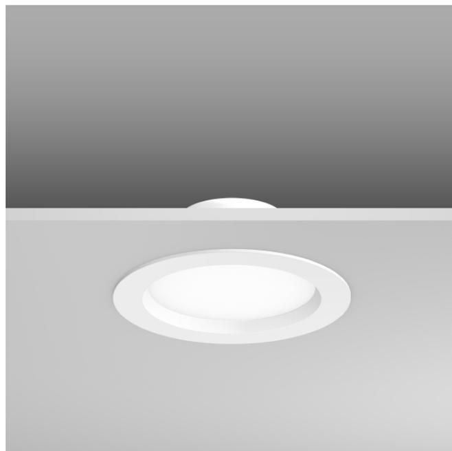
Downlight encastré rond. Corps en aluminium à revêtement synthétique. Refroidissement passif. Diffuseur en matière synthétique (polycarbonate) opalin, résistant aux chocs. MultiColour - température de couleur réglable via l'élément de commutation. 3000 K, 4000 K ou 5700 K. Réglé en usine sur 4000 K. Encastrement sans outil grâce à une fixation par ressort. Appareillage intégré.
